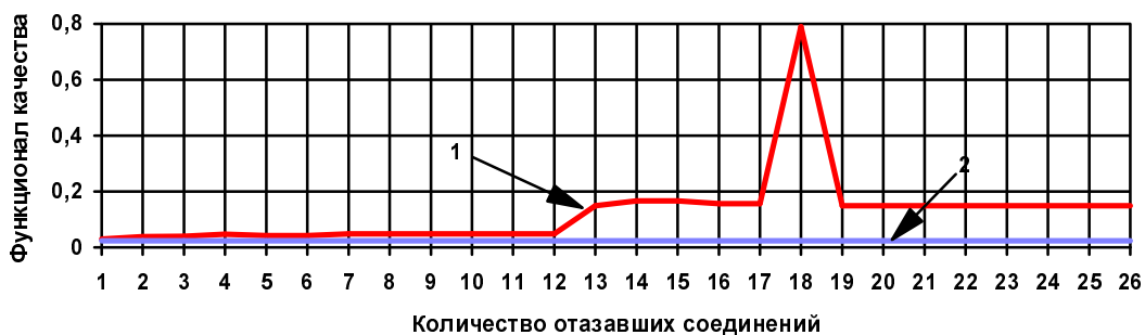
Рис. П1.7. Изменение качества работы системы управления при последовательном выходе из строя связей нейронной сети (кривая 1 — функционал качества для поврежденной системы, кривая 2 — для системы без повреждений)
