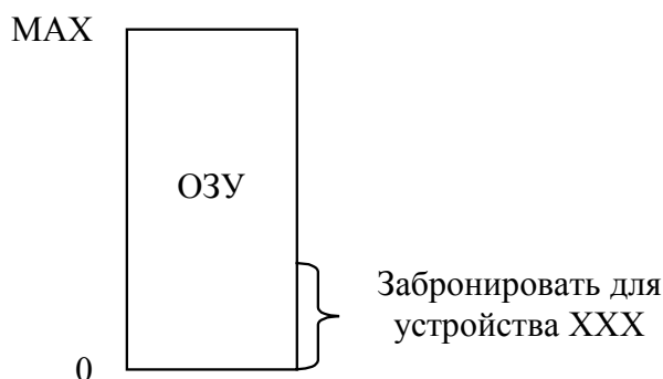
Рис. 23 Некоторые устройства предъявляют требования к адресам при работе в режиме прямого доступа к памяти
