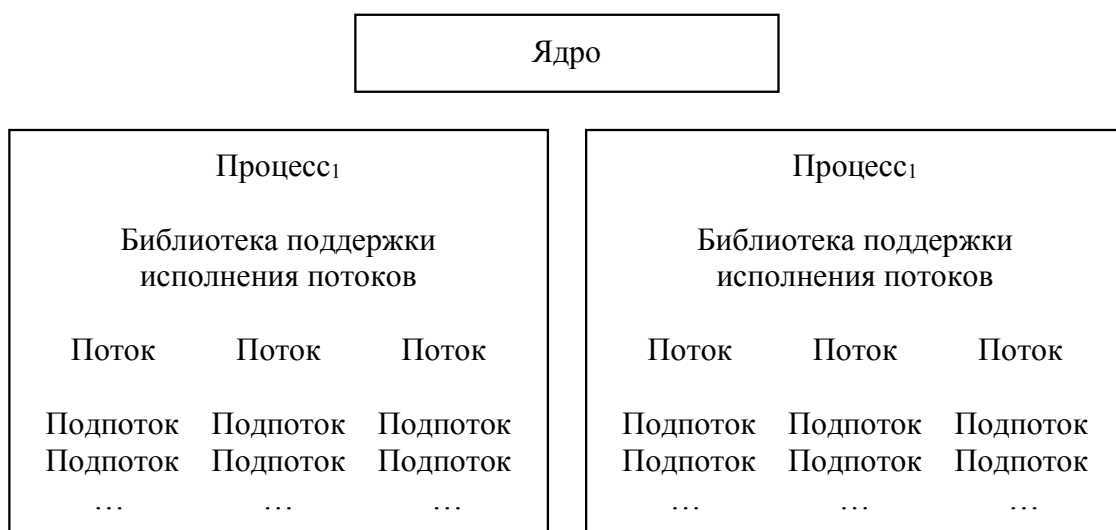
Рис. 5 Несколько процессов, у каждого процесса - несколько потоков, у каждого потока – несколько пользовательских подпотоков
