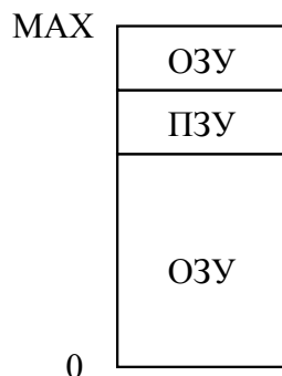
Рис. 21 Физическое адресное пространство, содержащее ОЗУ и ПЗУ
