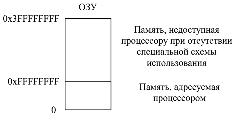
Рис. 24 Объем физической памяти превышает возможности адресации ЦПУ
