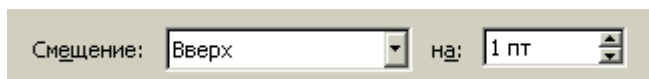
Рис. 36. Пример визуальной сборки команды из составляющих. Данный метод значительно проще для понимания, нежели, например, ввод положительного значения для смещения вверх и отрицательного значения для смещения вниз без поддержки раскрывающимся списком. Справа на иллюстрации крутилка (см. стр. 74).
