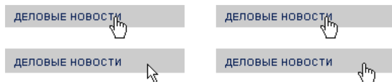
Рис. 31. Пример несоответствия видимой области кнопки её активной области. В примере слева кнопка нажимаема, когда курсор находится в пределах текста, но не нажимаема, когда он находится в пределах кнопки, но не в пределах текста. Справа правильный вариант.
