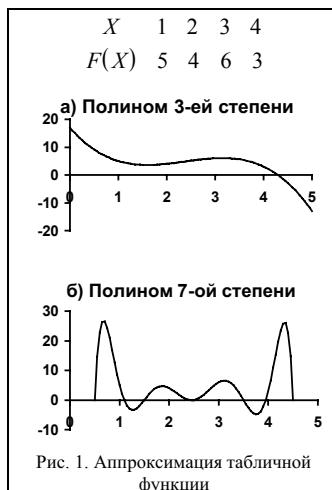
Рис. 1. Аппроксимация табличной функции
