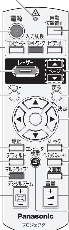
コンピューター信号を入力時に映像を投写しながらこのボタンを押せば、「表示位置」、「ドットクロック」、「クロックフェーズ」、「入力検出」を自動補正する (☞26 ページ)
