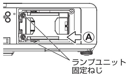
⑤ ランプユニット収納扉を取り付け、ランプユニット収納扉固定ねじ(2本)をプラスドライバーでしっかりと締め付ける。
