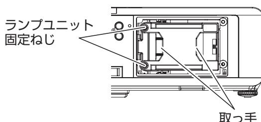
④ 新しいランプユニットを挿入方向に注意して押し込み、ランプユニット固定ねじ(2本)をプラスドライバーでしっかりと締めつける。
