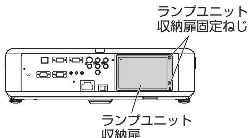
③ ランプユニットを固定しているねじ(2本)をプラスドライバーで空回りするまで回し、ランプユニットの取っ手を持ち、ゆっくりと本体から引き出す。
